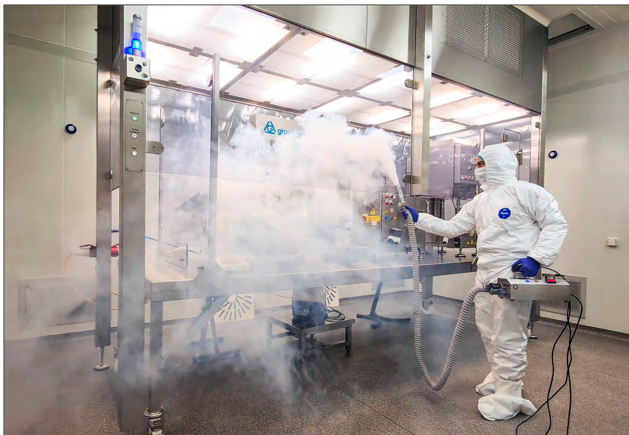
Визуализация воздушного потока с помощью генератора тумана KitAseptica FOG GEN®.
