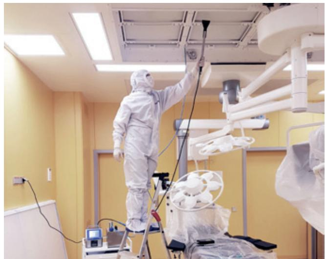
Рис.7. Проведение испытаний - проверка герметичности установки и целостности HEPA-фильтров (DOP-тест)
