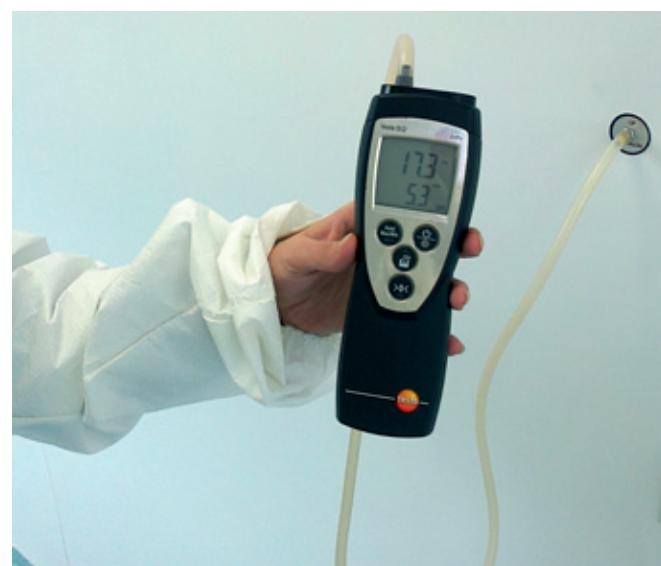
Рис.3. Проведение испытаний: измерение перепада давления с помощью дифманометра через порт  $\Delta P$ , установленный в сэндвич панели
