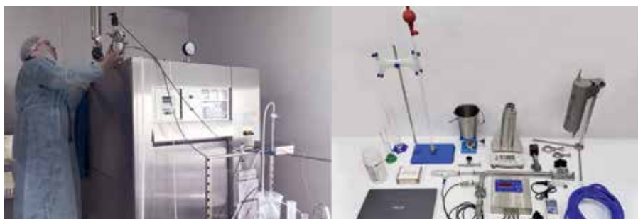
Рис.7. Подключение комплекта в точке потребления у автоклава для отбора проб
