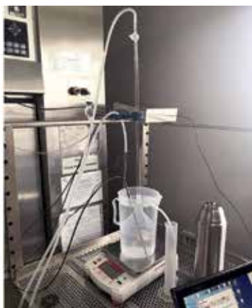
Рис. 4. Схема аппаратуры для определения перегрева пара
