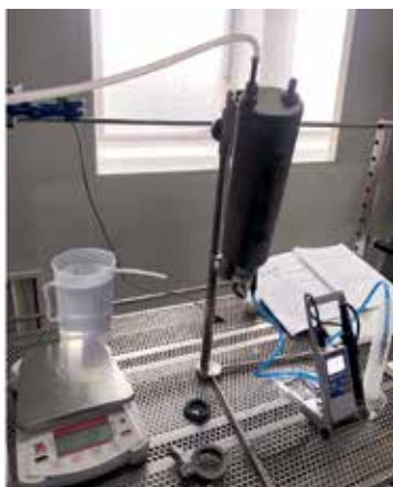
Рис. 5. Схема аппаратуры для определения неконденсируемых газов
