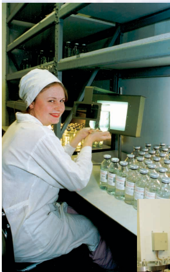
Прибор контроля растворов в поляризованном свете «Светлячок»™
