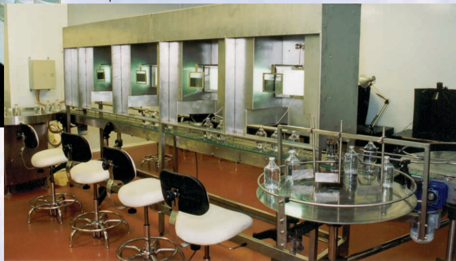
Прибор контроля растворов в поляризованном свете «Светлячок»™
